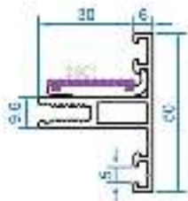
code : 3150 Add On پروفیل Add On Profile weight : 0.780 kg/m
